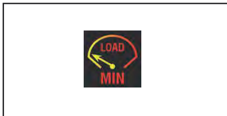
Fig. 146 Alarm stijging hoogwerkerbak
