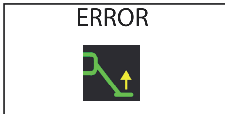
Fig. 128 Fout, hef de stabilisatiepoten van de grond op alvorens te gaan rijden
